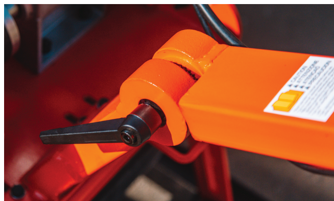
Механизм регулировки высоты рукоятки (модель VR300H)
